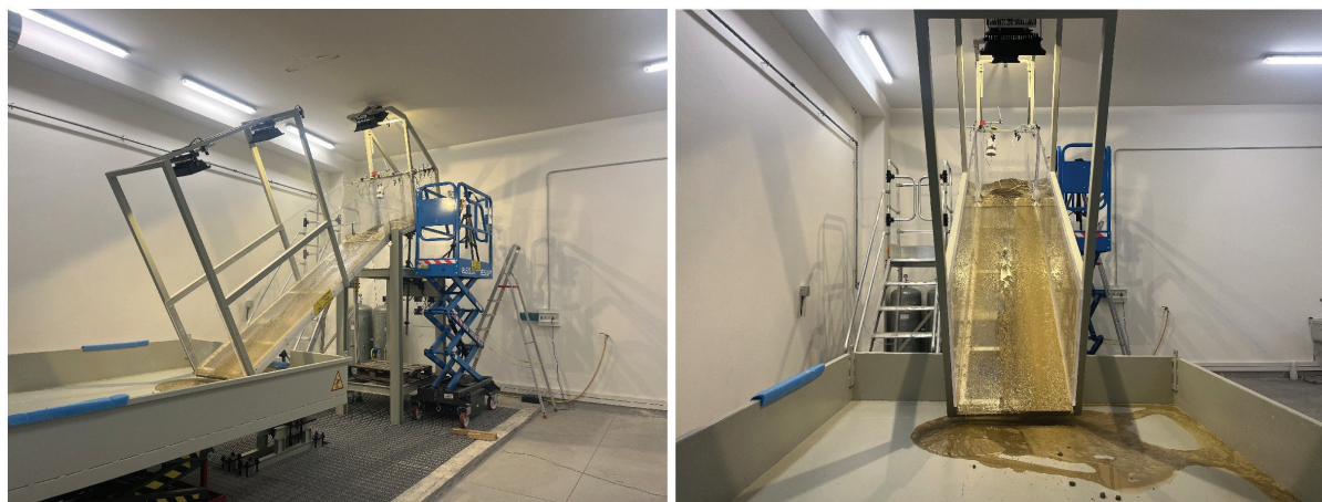
Figura 1 - Prototipo canaletta per la simulazione di colate detritiche.
