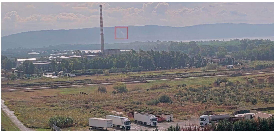
Figura 1 – Esempio di identificazione automatica di un pennacchio di fumo presso il sito pilota di Lamezia Terme tramite l'algoritmo di Visual AI sviluppato
