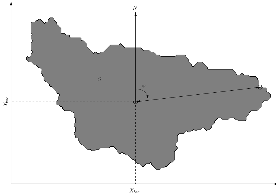
Figura 6.2: Esempio di calcolo dei parametri geometrici di bacino. S è la superficie del bacino, X_{bar} ed Y_{bar} le coordinate del baricentro del bacino e \varphi l'angolo del vettore di orientamento (che unisce il baricentro alla sezione di chiusura del bacino) con il nord N . Easting e northing sono, rispettivamente, EST = \sin \varphi e NORD = \cos \varphi .
