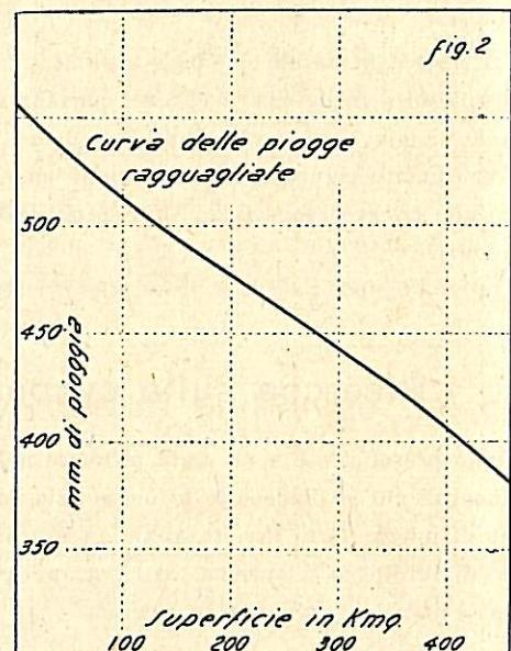
stazione pluviografica di Lavagnina, fu di 554 mm. e cadde in circa 8 ore; la massima precipitazione di un'ora fu, in questa stazione, di 115 mm. e quella di 2 ore di 182 mm. Per quanto riguarda la portata massima di piena del torrente si riscontrarono i seguenti contributi chilometrici: per un bacino di  $28,5 Kmq.$ ,  $mc/sec. Kmq. 20,7$ ; per quello di  $47,9 Kmq.$ ,  $mc/sec. Kmq. 20,5$  ed infine per tutt il bacino tributario del serbatoio di Ortiglio ( $Kmq. 141$ )  $mc/sec. Kmq. 16,2$ .
