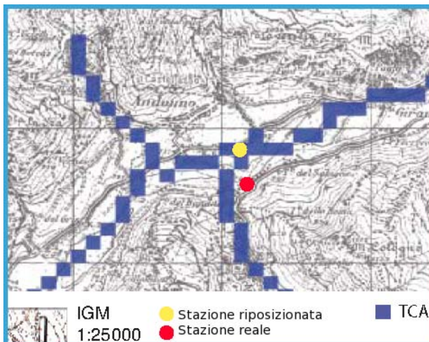
Figura 1: Esempio di riposizionamento di una generica stazione sul reticolo idrografico determinato automaticamente sulla base del modello digitale del terreno.
