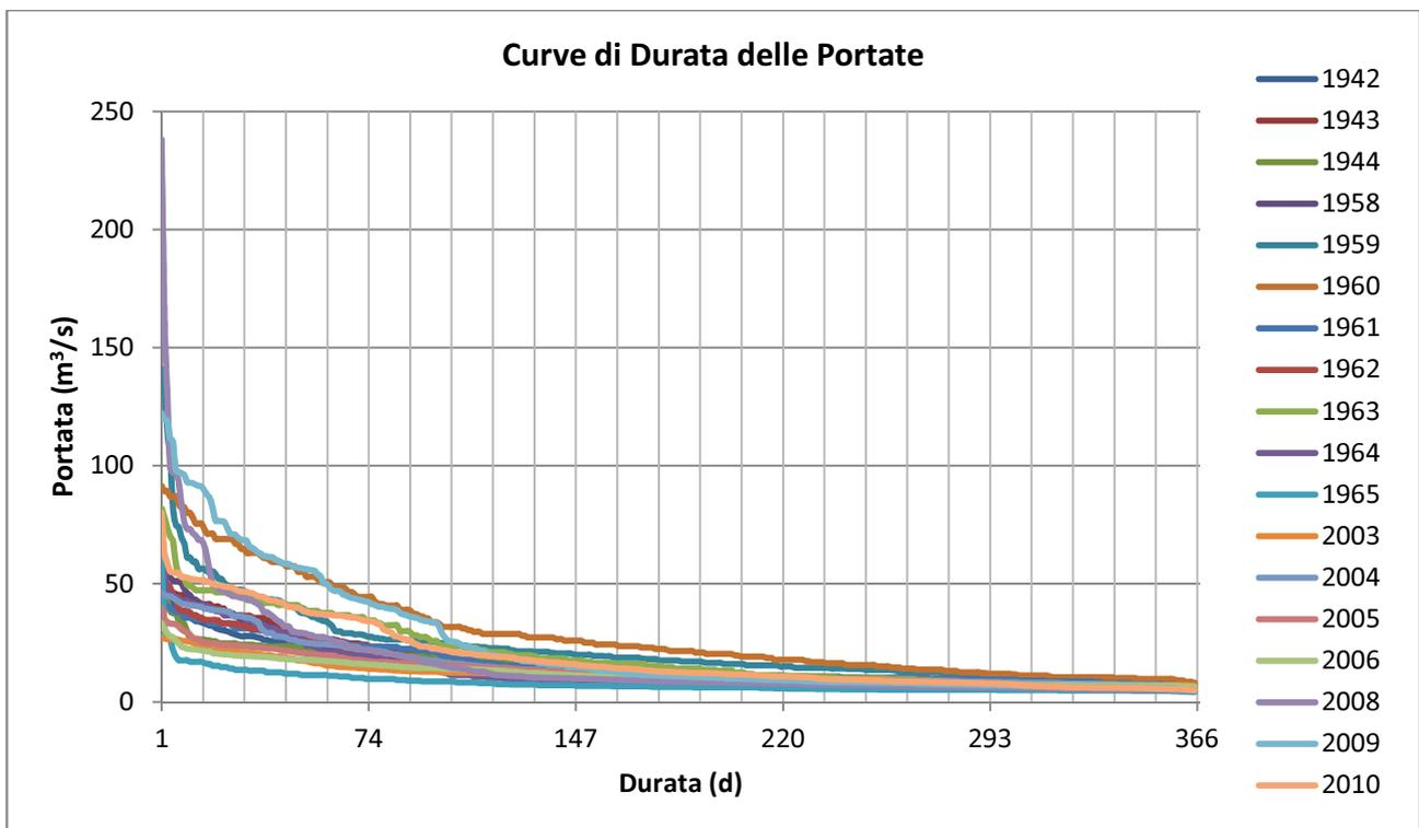
Figura 2. 3 Curve di durata delle portate
