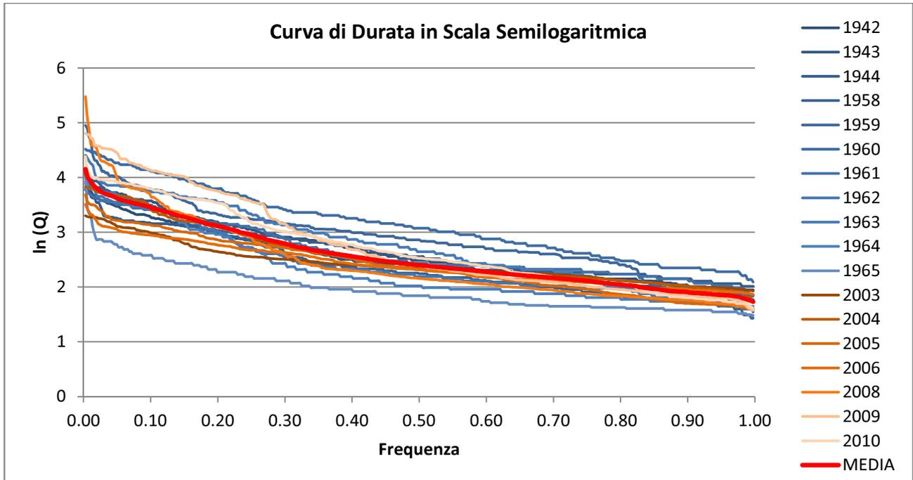
Figura 2.4 Curve di durata delle portate in scala semilogaritmica
