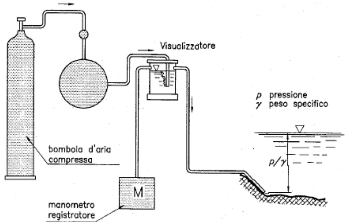
Fig. 5.2 Idrometrografo a bolle (Roche, 1963)
