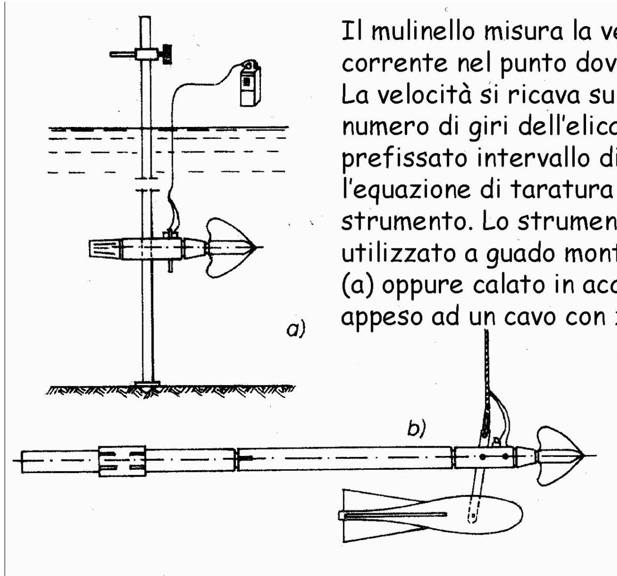
Il mulinello misura la velocità della corrente nel punto dove è immerso. La velocità si ricava sulla base del numero di giri dell'elica in un prefissato intervallo di tempo, nota l'equazione di taratura dello strumento. Lo strumento può essere utilizzato a guado montato su asta (a) oppure calato in acqua dall'alto appeso ad un cavo con zavorra (b).
