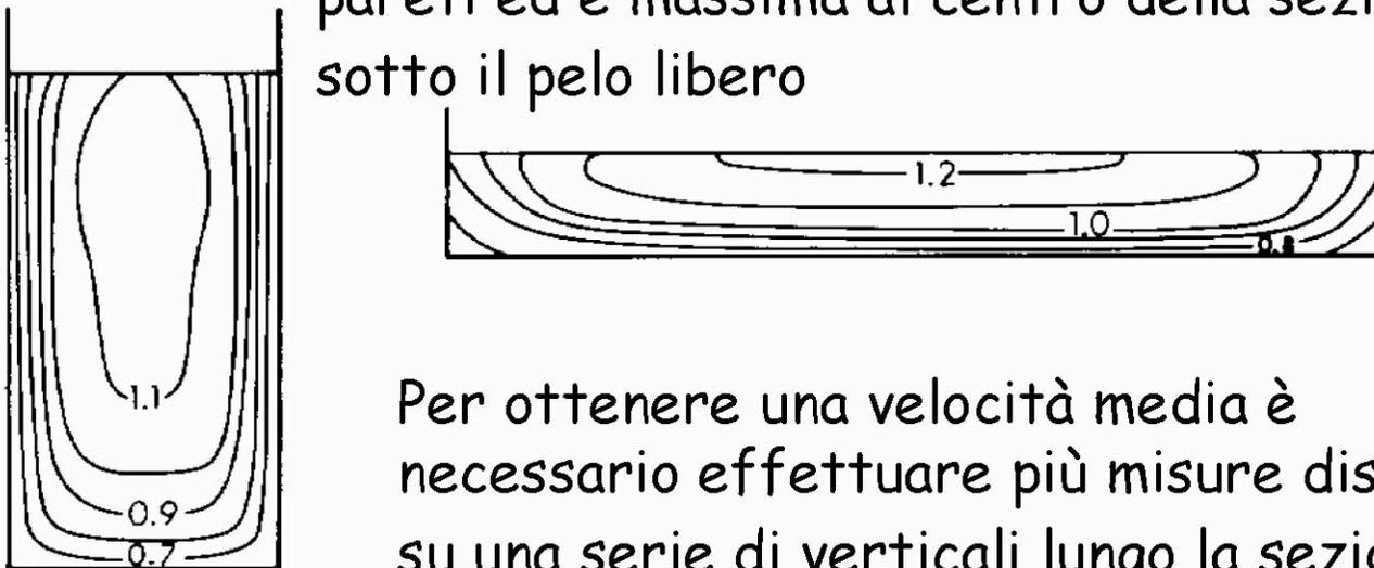
Per ottenere una velocità media è necessario effettuare più misure distribuite su una serie di verticali lungo la sezione
