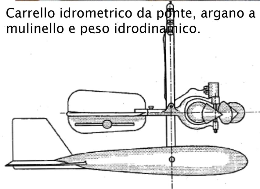
Fig. 5.8 Pesce con mulinello ad asse verticale (Linsley *et al.*, 1949) 7
