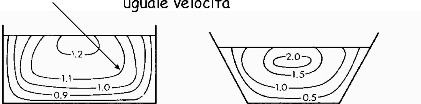
La velocità è inferiore in prossimità del fondo e delle pareti ed è massima al centro della sezione poco sotto il pelo libero
