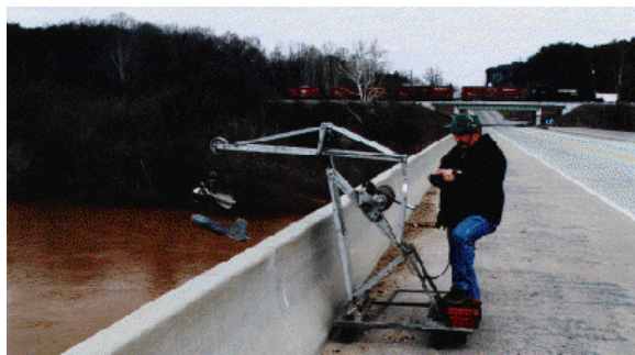
Carrello idrometrico da ponte, argano a mano, mulinello e peso idrodinamico.
