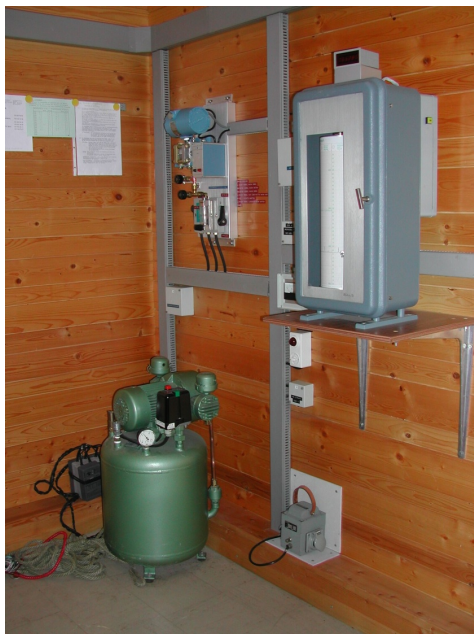
Fig. 5.2 Idrometrografo a bolle (Roche, 1963)
