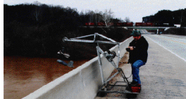
Carrello idrometrico da ponte, argano a mano, mulinello e peso idrodinamico.
