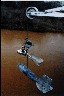
Misure con calata da ponte (mulinello + peso)
