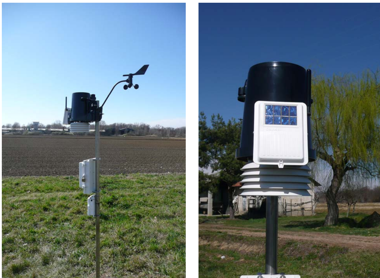
Figura 9.14: Stazione meteorologica installata presso il campo sperimentale di Lenta - Cascina La Rinascita.
