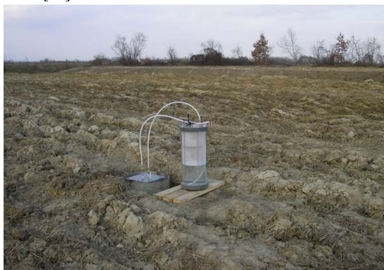
Figura 3.1: Misura di conducibilità idraulica satura in campo mediante doppio anello a carico costante.
