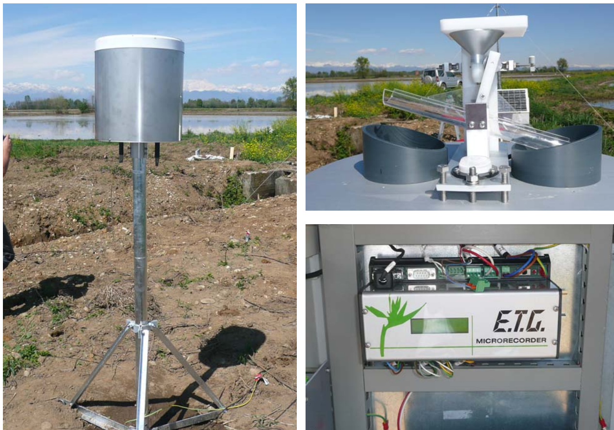
Figura 9.16: Pluviometro installato presso il campo di prova di Albano - Cascina Nuova e particolare del display della centralina meteorologica.
