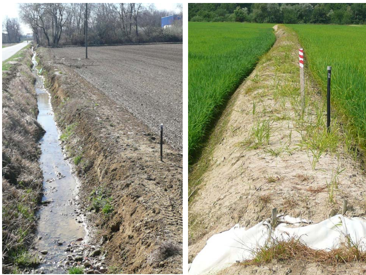
Figura 9.21: Esempi di tubi piezometrici installati nei pressi di un fosso irriguo (P10) e sull'arginello separatore tra due risaie (P3).
