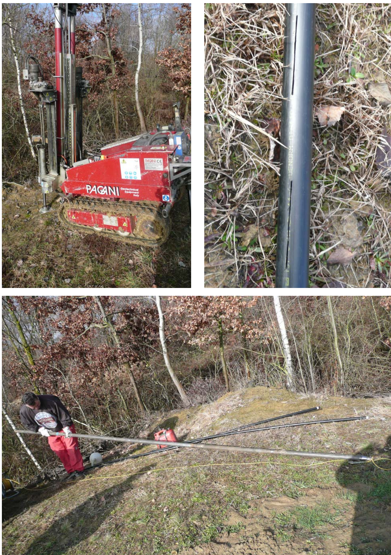
Figura 9.19: Il penetrometro dinamico pesante adottato l'installazione dei piezometri (tipo Pagani TG 63-100 EML.C), le fessure nei tubi ed un'immagine di aste e piezometri.
