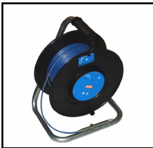
Figura 9.22: Freatimetro per il monitoraggio della falda.
