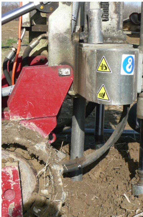
Figura 9.20: Il tratto terminale di un tubo piezometrico con la punta metallica adottata per l'infissione e un'immagine del penetrometro dinamico in azione.
