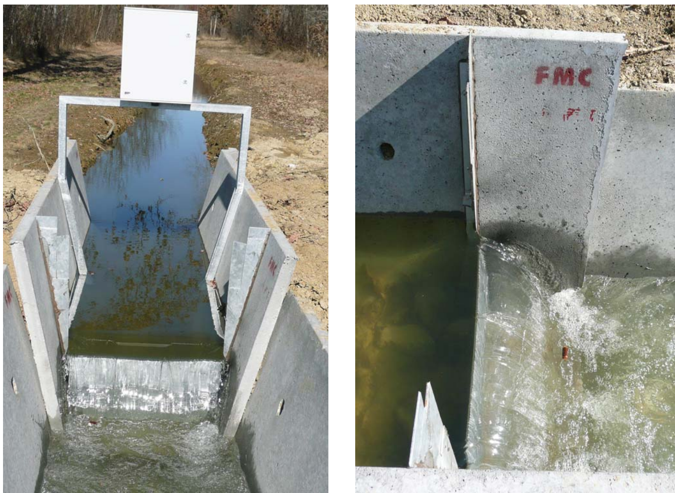
Figura 9.10: Lama d’acqua che si forma al passaggio attraverso la sezione sfiorante all’interno di una canaletta nel campo sperimentale di Lenta.
