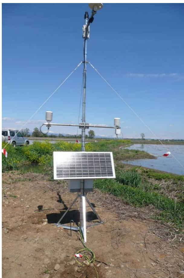
Figura 9.15: Stazione meteorologica installata ad Albano Vercellese.
